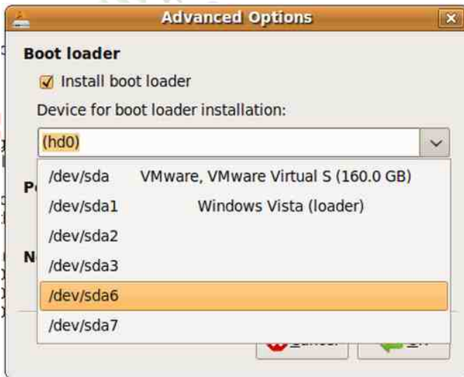
Afbeelding 11: We moeten een boot loader hebben voor Ubuntu omdat we anders het systeem niet op kunnen starten.
