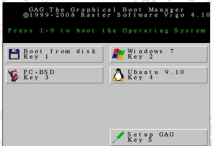
Afbeelding 14: Met de installatie van het boot menu is onze multiboot computer klaar voor gebruik.
