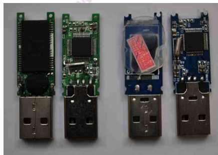
Het binnenwerk van onze nep-sticks van 2 en 16 gigabytes
