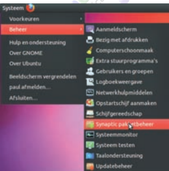
Figuur 15: Synaptic pakketbeheer is de tool voor geavanceerd beheer van de software onder Ubuntu.
