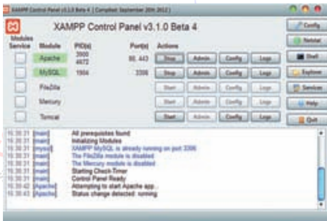
Afb. 1 Het controlescherm van XAMPP, waarmee u (onderdelen van) de lokale server kunt starten en stoppen
