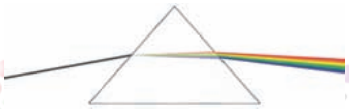
afb.2: breking door prisma
