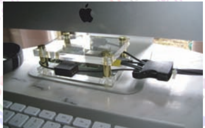
Afbeelding 2 Raspberry Pi, aangesloten via het netwerk bediend door een andere computer
