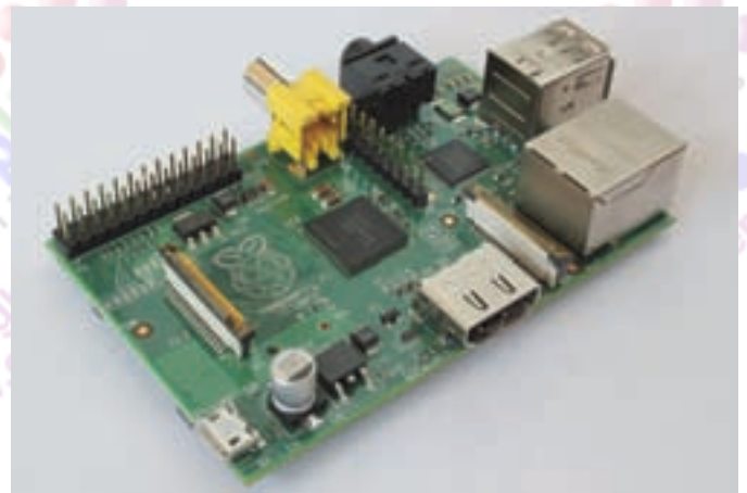
Afbeelding 3 Raspberry Pi model B, type 2
