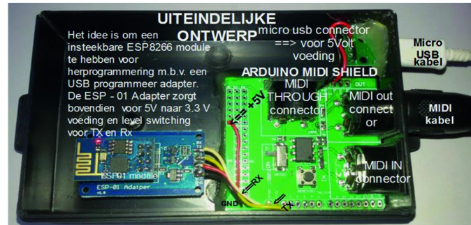
Afbeelding 7: ESP8266 OSC naar MIDI module
