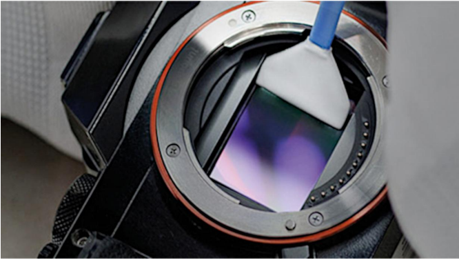
Gebruik de juiste (breedte)maat voor de swab. Net zo breed als de sensor
