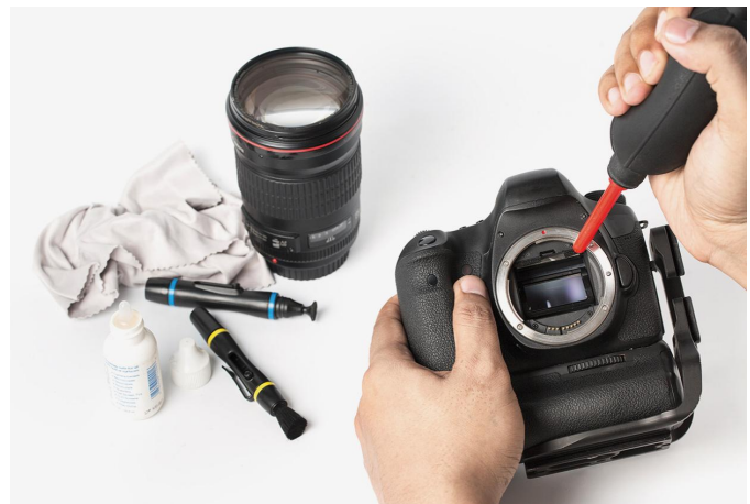
Geén lenspen of blaasbalg gebruiken voor het reinigen van de sensor
