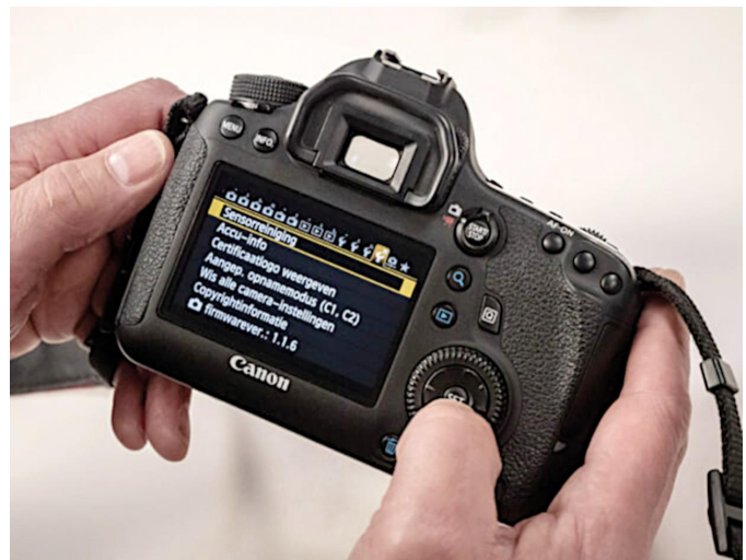
Camerasetting voor het opklappen van de spiegel, om bij de sensor te komen
