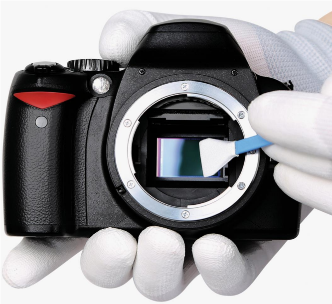
Zorgvuldig reinigen van de sensor in twee bewegingen
