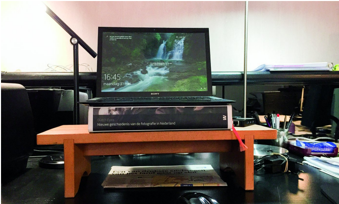
Afbeelding 4: Door de laptop hoog te zetten komt de camera meer op ooghoogte. Dat geeft minder vertekening van het beeld. Dit is vooral van belang voor sprekers. Er staan twee daglichtlampen (links en rechts) en een adaptor voor een vaste internetverbinding (rechts naast de laptop).
